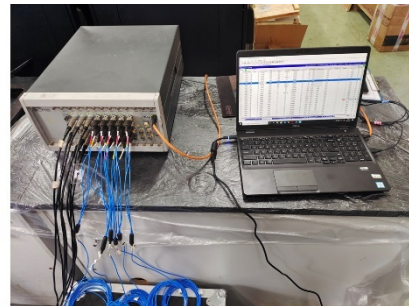
图 1 LMS 数据采集系统及测试软件
