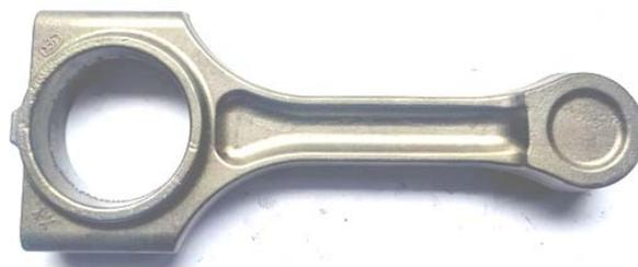
图9 TC4钛合金连杆锻造毛坯
