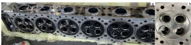
图 1 (a) 六缸整体盖火力面 (b) 单缸气缸盖火力面
