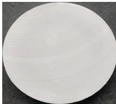
图 3 棒材挤压态尾端低倍组织
