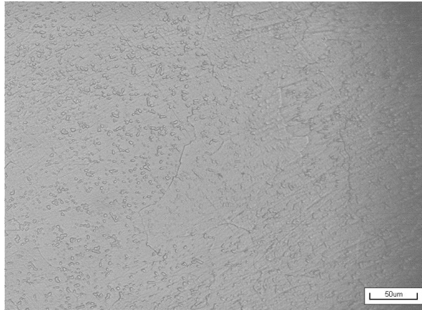
图 7 尾端淬火棒材边部显微组织
