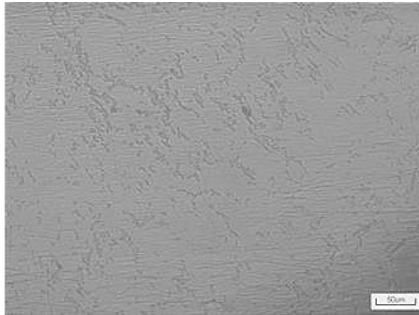
图6 头端淬火棒材中心部位显微组织
