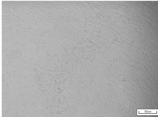
图 8 尾端淬火棒材中心部位显微组织
