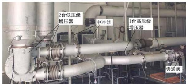
图 7 两级增压试验台
