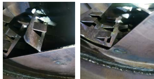
图12 1.5倍尿素喷射量的混合器内部结晶情况示意图
