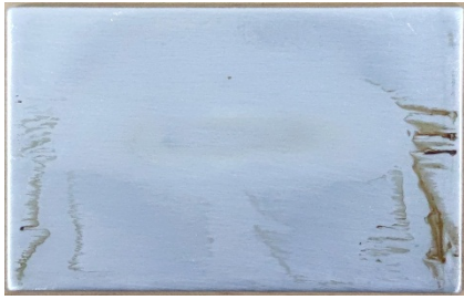
图 3 CN98 模拟进气阀沉积物测试试片
