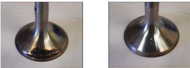
图 4 CN98 品牌汽油的 M111 台架进气阀沉积物生成情况
