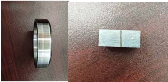
图 17 10%水、5%氢气乳化机油摩擦试验环块图
