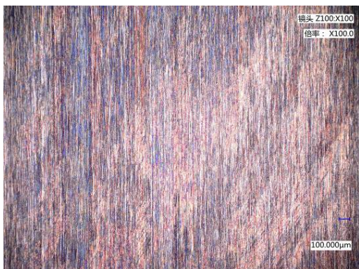
图 29 10%水、5%氢气基础油放置三天后摩擦磨损试验标准试验环微观结构图
