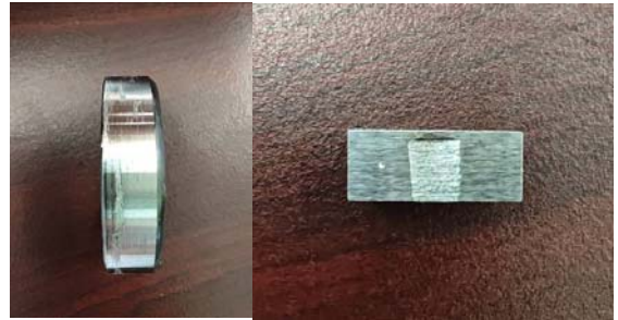
图 14 10%水、0%氢气乳化机油摩擦试验环块图
