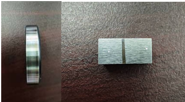
图 11 5%水、10%氢气乳化机油摩擦试验环块图
