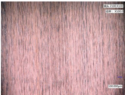
图 19 10%水、5%氢气基础油摩擦磨损试验后标准试验环的微观结构图
