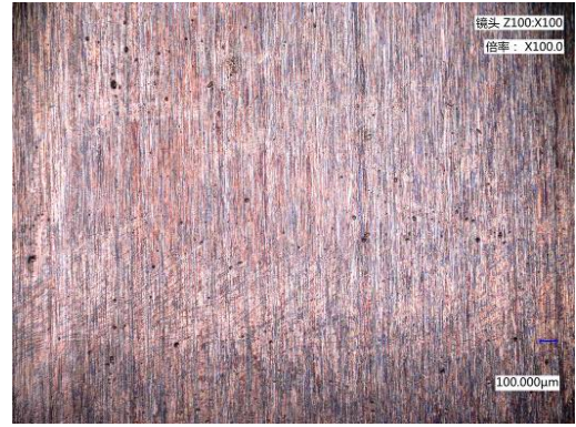
图 13 5%水、10%氢气基础油摩擦磨损试验后标准试验环的微观结构图
