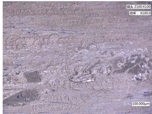
图9 0%水、0%氢气基础油摩擦磨损试验后标准实验块的微观结构图
