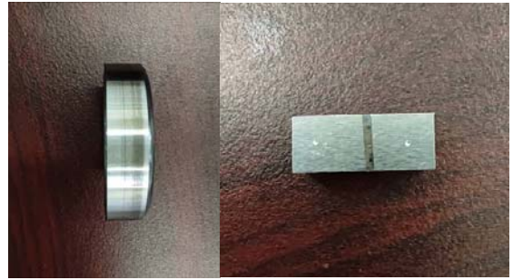
图 20 10%水、20%氢气乳化机油摩擦试验环块图
