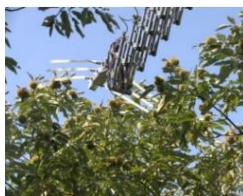
图 19 板栗拍打式工作机工作场景
