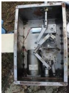
图 17 林果振动采摘装置试验样机
