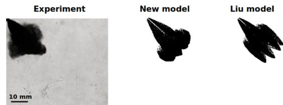
图 5. 纯蒸发工况下不同阻力模型的液相分布对比
