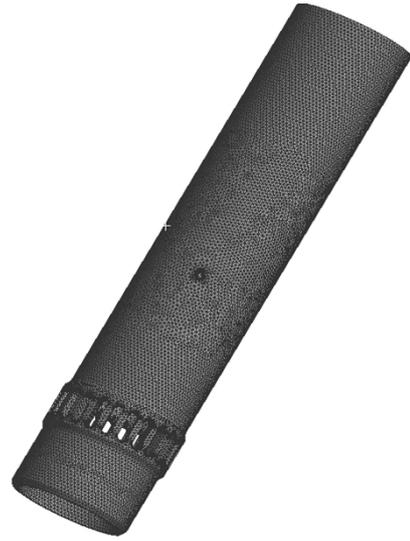
图 13 缸套有限元体网格模型
