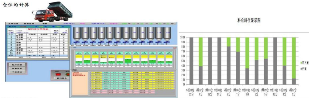
图 2 料仓料量的软测量实施效果图
