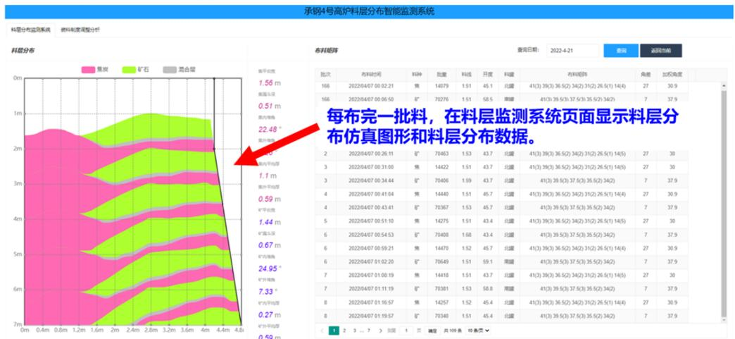
图 10 料层分布、料层数据和料制参数
