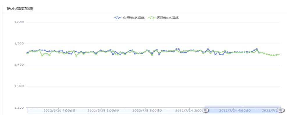
图 6 铁水温度预测界面
