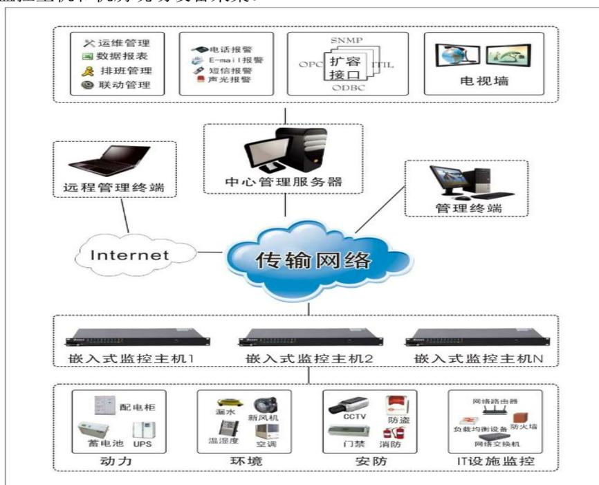
1) 机房监控中心：是整个机房监控系统的核心，由监控服务器、报警平台、监控显示屏及相关维护终端组成，负责对所有联网监控机房的消防、动力、环境子系统进行实时监测和智能化调节控制以及监控数据的存储、分析、机房的管理；
