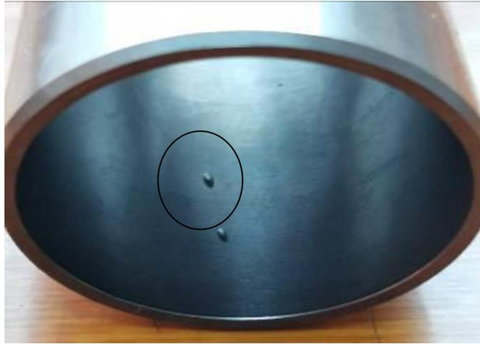
图 1 样品的内壁鼓泡缺陷
