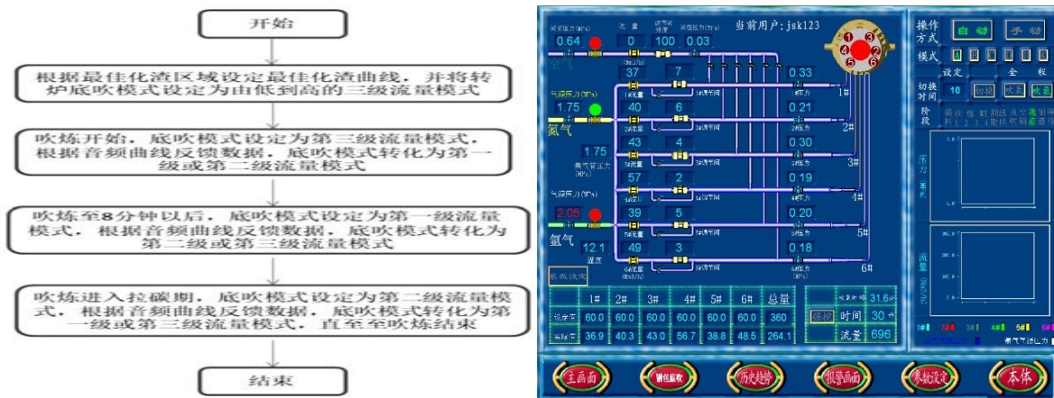
图 3 音频化渣控制底吹流量工艺流程
