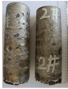
图 3 两种渣系冶炼电渣锭表面形貌
