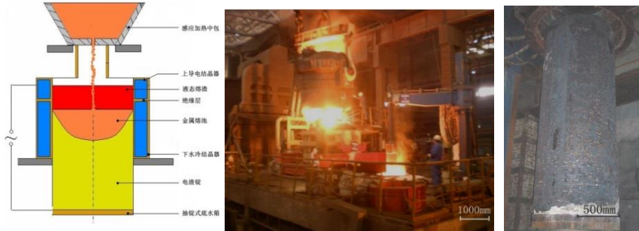
图3 (a) 电渣液态浇铸过程示意图； (b) 15 吨电渣液态浇铸炉； (c) 电渣锭
