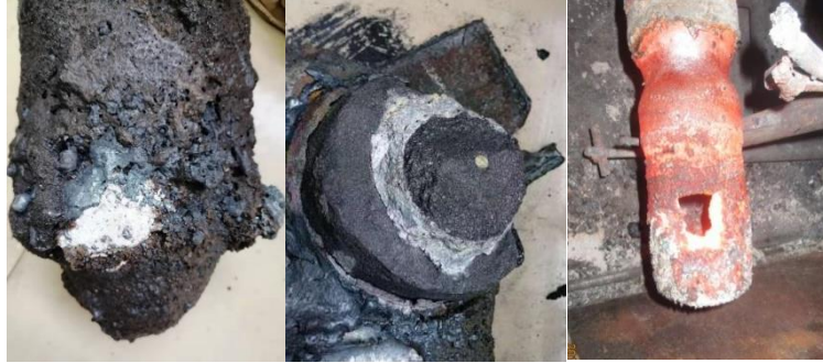
图 1 非钙处理浇次塞棒、上水口和结晶器 SEN 水口
