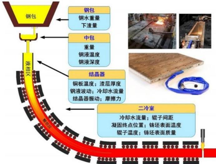
图2 连铸机重要传感器及检测信息
