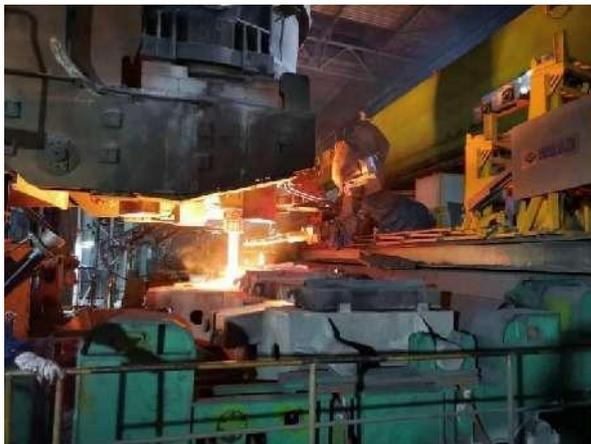
图 3 机器人安装长水口
