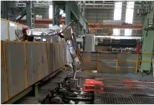
图 8 机器人喷号
