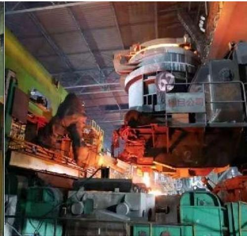
图7 机器人加覆盖剂
