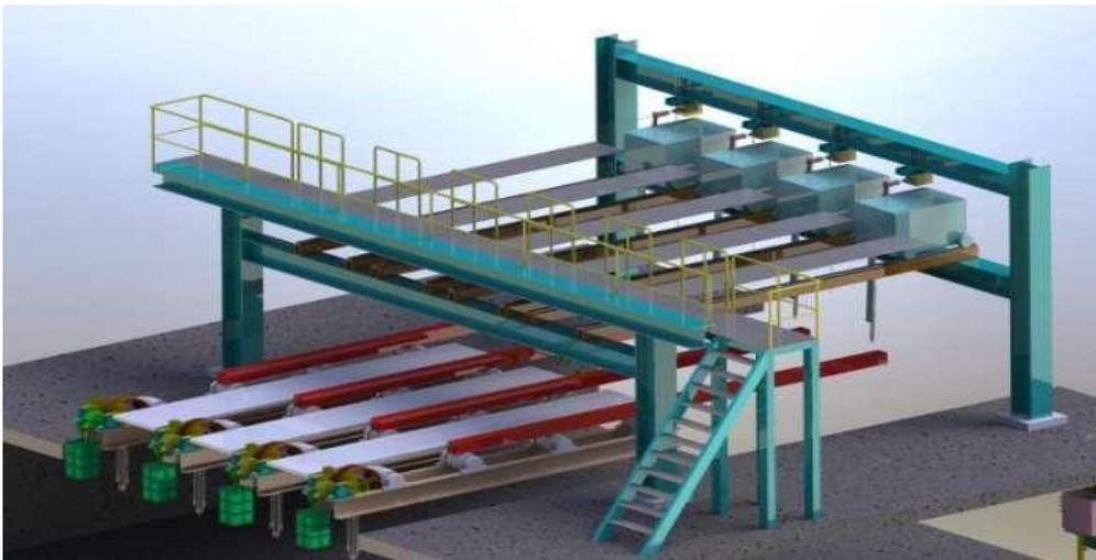
图 15 激光定重定尺三维效果图
