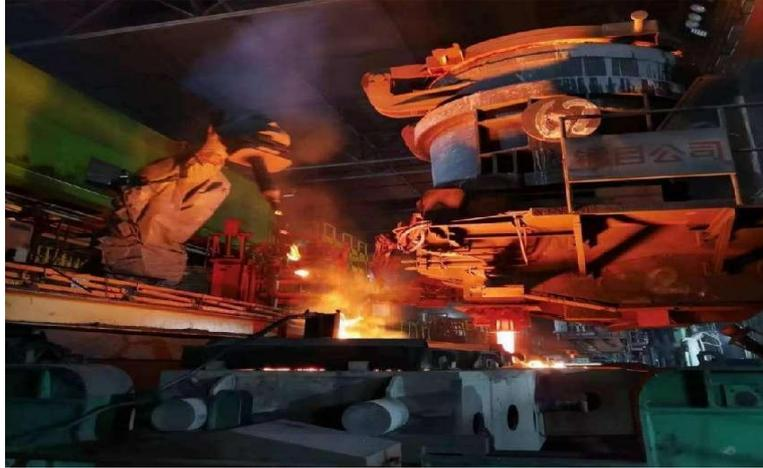
图5 机器人测温取样
