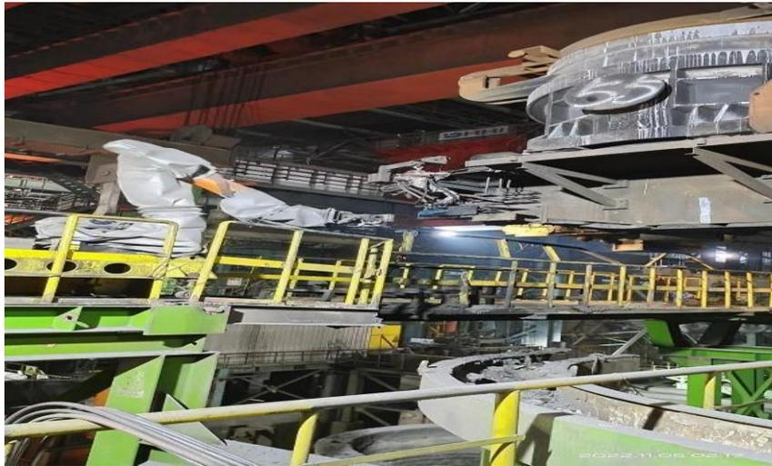
图 2 机器人拆装滑板油缸
