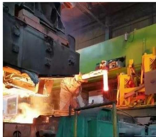
图 4 机器人取长水口
