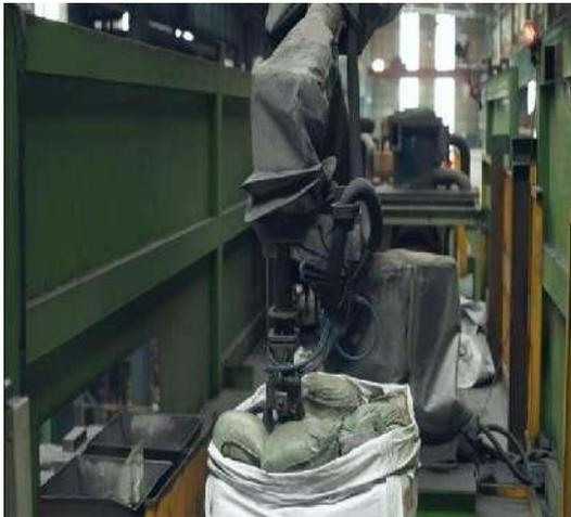
图6 分拣覆盖剂机器人
