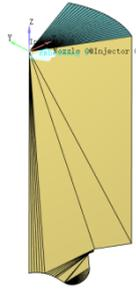
图1 燃烧室三维几何模型
